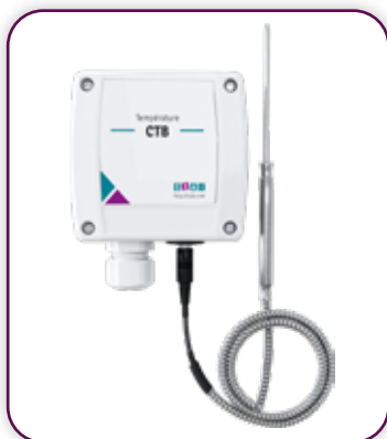
Boîtier entrée Pt100/Pt1000 sortie 4-20 mA / 0-10 V avec connecteur jack
