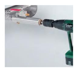
Au cas où le système ne pouvait pas être éteint, il est possible d'utiliser le collier de perçage (numéro de commande 0530 1108) et le gabarit de perçage (référence 0530 1108) pour percer la vanne à boisseau .
