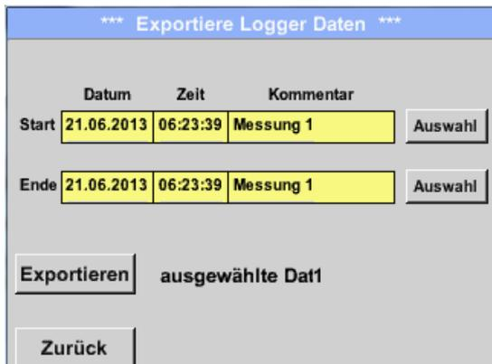
Le bouton *Sélection* permet de régler un espace de temps entre *Démarrage* et *Arrêt*. Les données de mesure sauvegardées enregistrées pendant ce laps de temps sont exportées.
