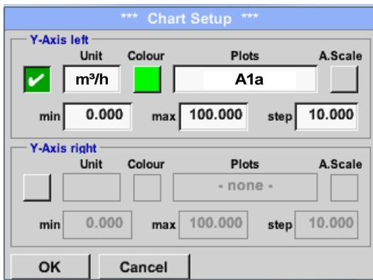
Il est maintenant possible d'ajuster l'échelle pour les axes y, avec *min.*, *max.* et *trame*.
