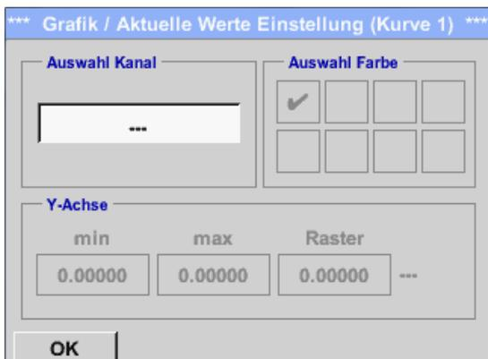
Ici, c'est le canal A1 qui est sélectionné. Il est possible de sélectionner pour chaque canal une valeur pour la représentation sous [Graphique](#). En outre, il est possible de sélectionner, tout comme dans le [Menu principal → Graphique](#), une [Couleur](#) et une échelle des axes y ([min](#), [max](#), [trame](#)).
