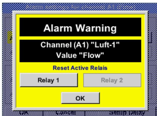
Si une alarme apparaît, p. ex. l'alarme 1 (jaune) du canal A1 comme indiqué ici, un message s'incruste. Si une autorisation de désactivation du relais a été donnée sous *Relais Settings*, l'actionnement du bouton *Relais 1* le mettra hors service. Le message peut être supprimé en pressant le bouton *OK*.
