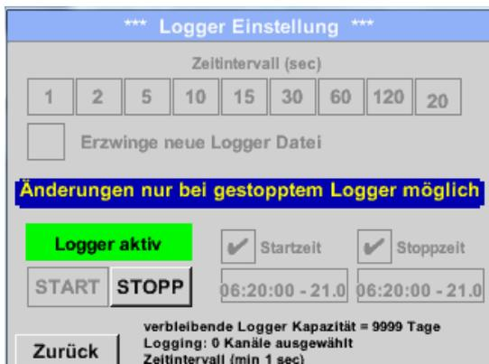
Après avoir activé *Temps de démarrage* ou *Temps d'arrêt* et effectué le réglage, il faut appuyer sur le bouton *Démarrage* ; l'enregistreur de données est ajusté sur *activé*.
