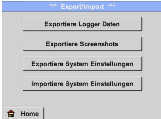
*Exporter les données de l'enregistreur de données, Exporter la capture d'écran et Exporter le réglage du système* permettent de transmettre les données de mesure enregistrées, les captures d'écran et les réglages du système à une clé USB.
