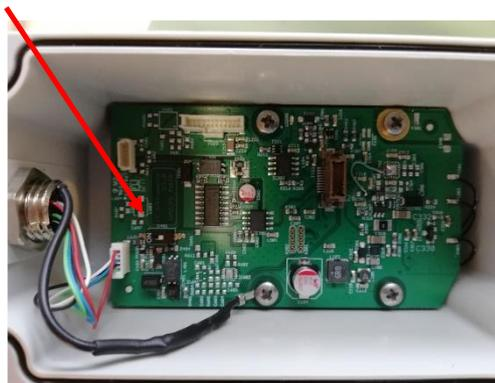
Alternativement, une résistance 120R peut être installée dans la fiche entre la broche 2 et la broche 4. Il faut s'assurer que les fiches de connexion sont toujours bouchées et que le joint est correctement installé.
