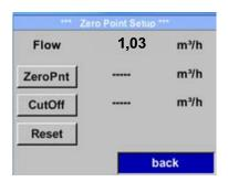
En pressant "Reset" les réglages "ZeroPnt" et. "CutOff" sont remis à zéro.
