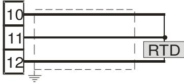
Fig. 5 Connexion de thermorésistance
