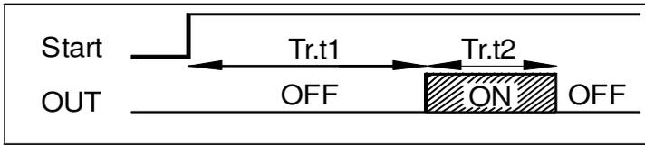
Retard à la mise en fonction avec un temps de retard et un temps de "fin de cycle"
