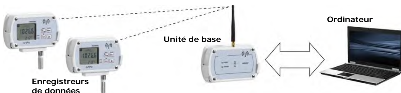
Fig. 2.1: unité de base interposée entre les enregistreurs de données et l'ordinateur
