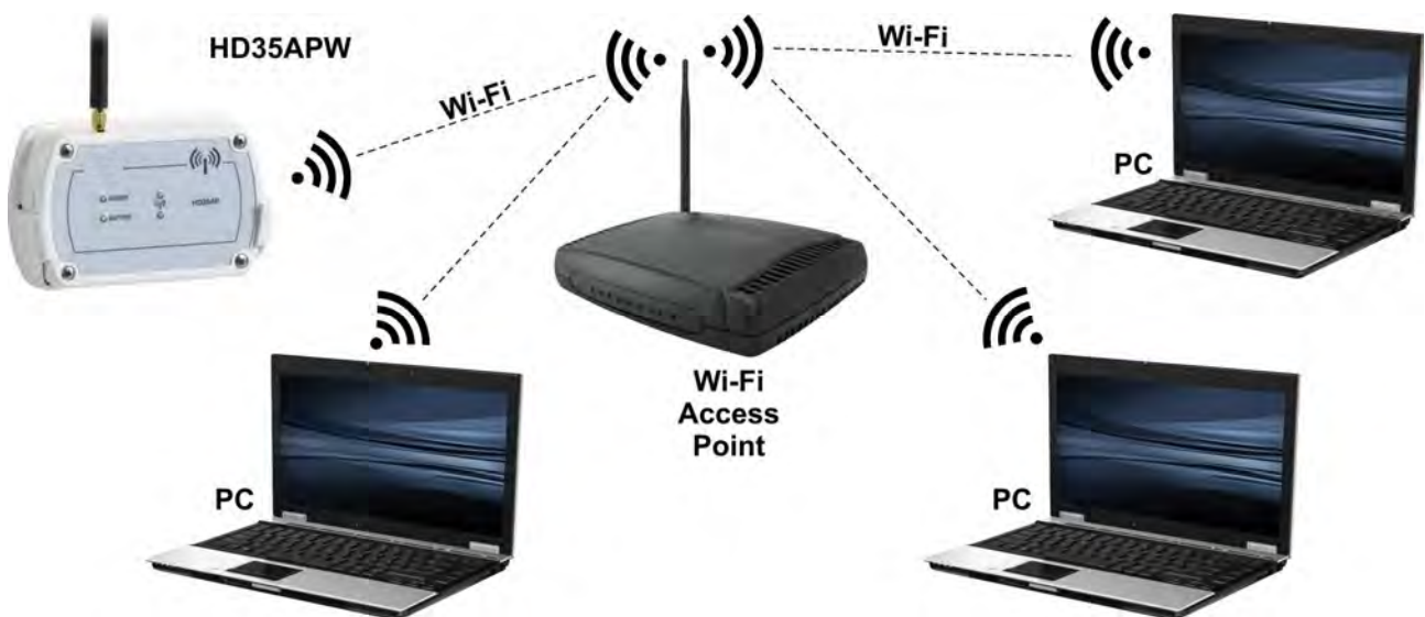
Fig. 6.5.2: unité de base en mode Wi-Fi fonctionnant comme client
