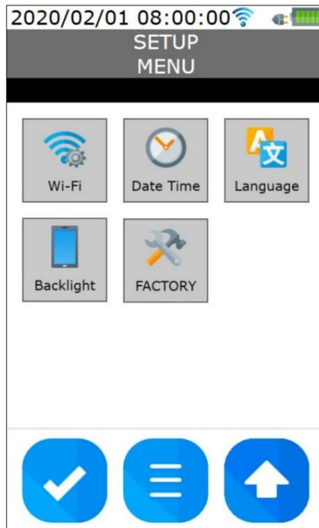
Le sous-menu USINE comprend des fonctions avancées du système pour la maintenance technique de l'instrument et est accessible après la saisie d'un mot de passe numérique.
