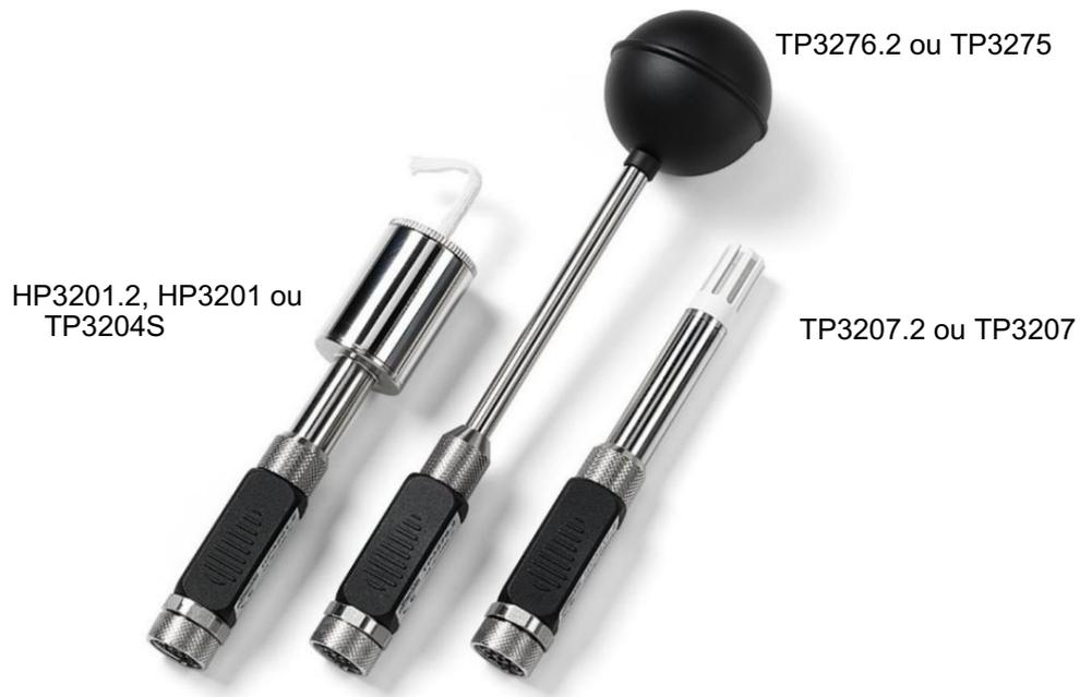
Sondes nécessaires pour la mesure des indices PMV/PPD :
