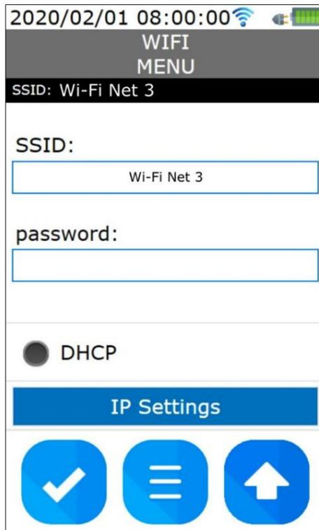
Sélectionnez DHCP (Dynamic Host Configuration Protocol) pour obtenir automatiquement une adresse IP dynamique du réseau. Après connexion, l'adresse dynamique attribuée par le réseau à l'instrument est visible en appuyant sur « Paramètres IP ». Pour saisir manuellement une adresse IP statique, désélectionnez DHCP et appuyez sur « IP Settings », puis configurez l'adresse et confirmez en appuyant sur la touche « check ».
