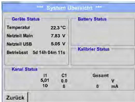
Le point de menu *Vue d'ensemble du système* fournit des informations relatives aux tensions et courants appliqués des *canaux* individuels ou de l'ensemble des canaux ainsi que relatives à l'alimentation électrique des *Blocs d'alimentation*.
