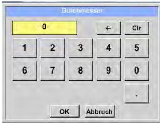
Il est possible d'entrer ici le *Diamètre intérieur* de la conduite d'écoulement si celui-ci ne s'inscrit pas automatiquement et correctement.
