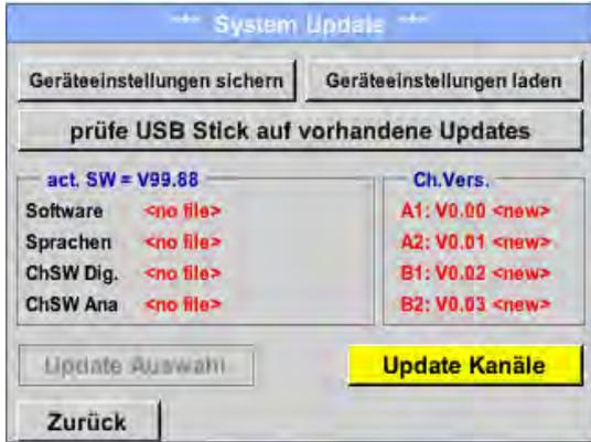
Si, après avoir appuyé sur le bouton *Vérifier la présence de mises à jour sur la clé USB*, les messages suivants s'affichent dans la fenêtre, le DS 500 n'est pas correctement relié à la clé USB ou aucun fichier n'est présent.
