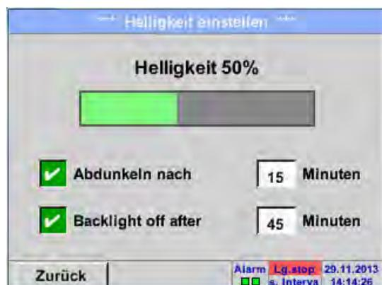
L'actionnement du bouton *Assombrir au bout de* permet de réduire la *Luminosité* au bout d'une période définie (ici au bout de 15 minutes) à la valeur minimale ou de mettre l'appareil complètement hors tension.
