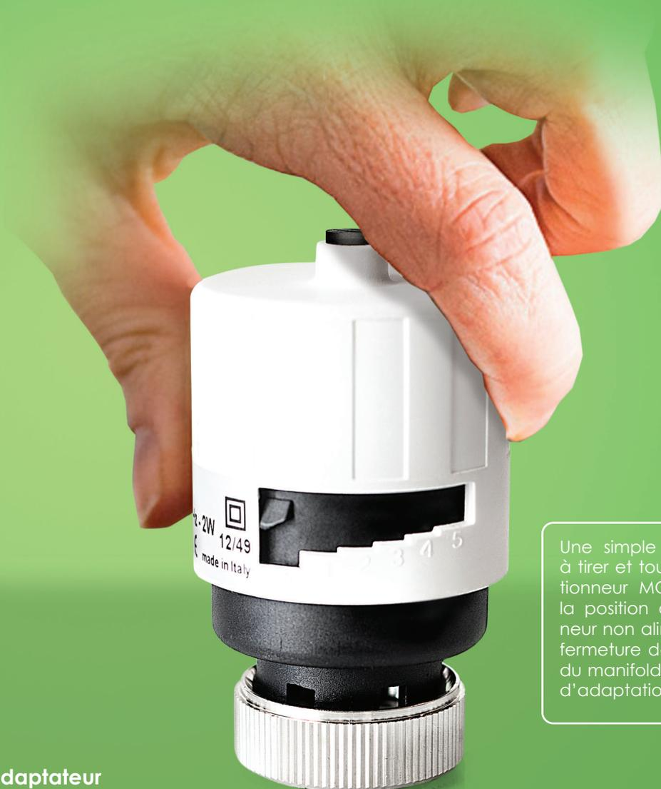
Une simple procédure consistant à tirer et tourner le capot de l'actionneur MCA permet d'adapter la position du piston de l'actionneur non alimenté à la position de fermeture de la tige de la vanne/du manifold, sans besoin de pièce d'adaptation intermédiaire.
