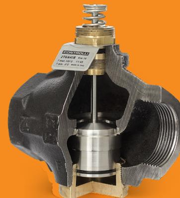
Série **2TBB** - 2 voies, corps bronze, connexions filetées jusqu'à 2", clapet laiton, tige acier inoxydable. Température de -10°C à 130°C. Rangeabilité 50:1.
