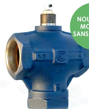
Vannes 3 voies bidirectionnelles série **3TBB**, corps bronze, raccords laiton, tige en acier inoxydable. Température du fluide : de -10°C à 130°C. Rangeabilité 50:1.
