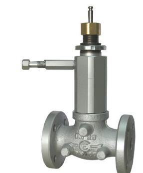
Pour éviter les problèmes d'usure des sièges et des clapets, nous recommandons de ne pas dépasser une pression différentielle de 8 bar (2FSA & 2FAA) & 12 bar (2FAAP).
