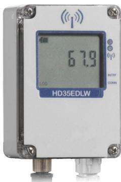
Enregistreur de données sans fil de PRESSION NIVEAU Boîtier étanche IP 67. Affichage LCD personnalisé (uniquement avec l'option L). Il stocke les mesures dans sa mémoire interne (28 000 échantillons) et transmet automatiquement les données enregistrées à l'unité de base, à intervalles réguliers ou sur demande.
