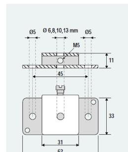
Brides de fixation acier zingué avec vis d'arrêt, livré avec joint silicone plat ep. 3 mm
