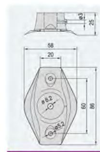
**Bride de montage plastique avec PE M16 x 1,5 température : -50 +100 °C**
