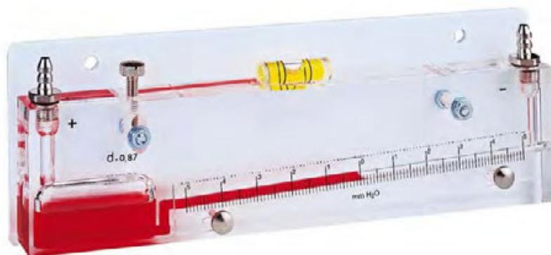
Les manomètres à colonne de liquide inclinée de la gamme TX sont destinés aux mesures de faibles variations de pression, dépression, pression différentielle.
