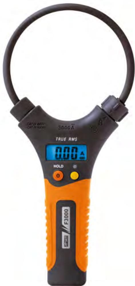
La pince ampèremétrique professionnelle F3000 est conçue pour mesurer le **courant AC jusqu'à 3000A** en **TRMS** en mode **autorange** pour l'obtention des **CAT IV 600V**, **CAT III 1000V** selon la norme **IEC/EN61010-1**.
