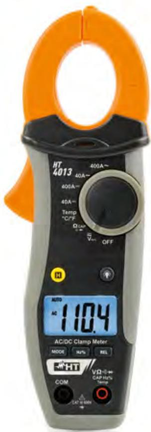
La pince ampèremétrique HT4013 est conçue pour la mesure du **courant AC/DC jusqu'à 400A et tension AC/DC jusqu'à 600V** pour l'obtention de la **CAT III 600V** en accord avec la norme **IEC/EN61010-1**.
