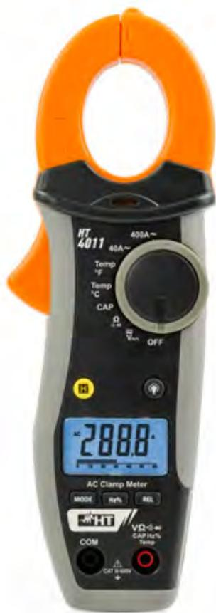
La pince ampèremétrique HT4011 est conçue pour la mesure du **courant AC jusqu'à 400A** et **tension AC/DC jusqu'à 600V** pour l'obtention de la **CAT III 600V** en accord avec la norme **IEC/EN61010-1**.
