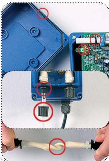
**Degré de protection IP 65 et isolation électrique classe 2** (sans connexion à la terre)
