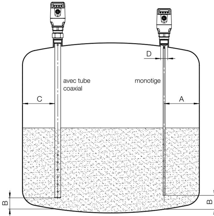
Instrument monotige monté dans une cuve métallique
