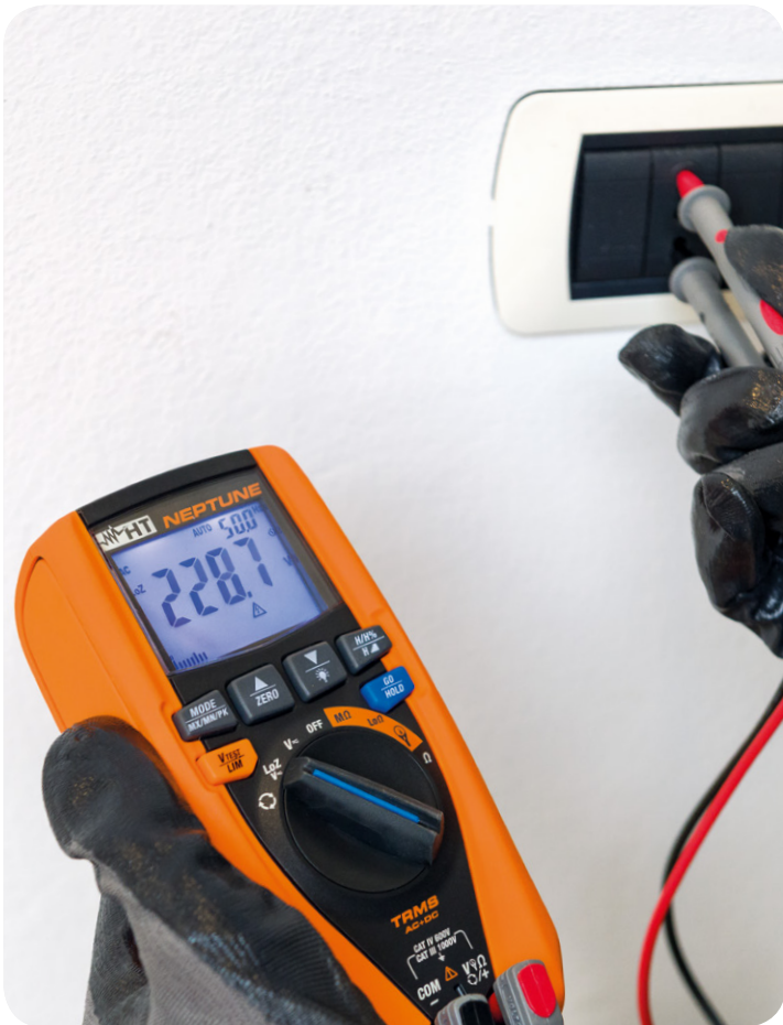
Mise à zéro de la tension parasite.
