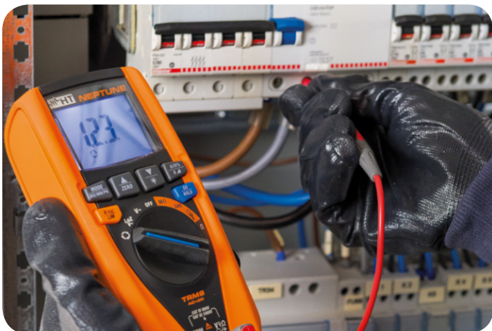
Mesure de la séquence de phase avec un conducteur.
