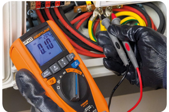
Continuité des conducteurs de protection.
