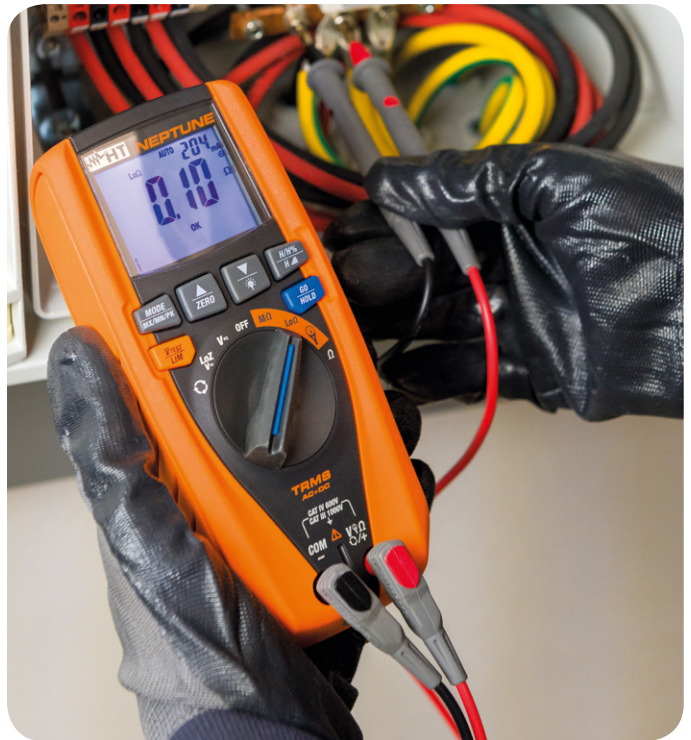
Continuité des conducteurs de protection avec 200mA.
