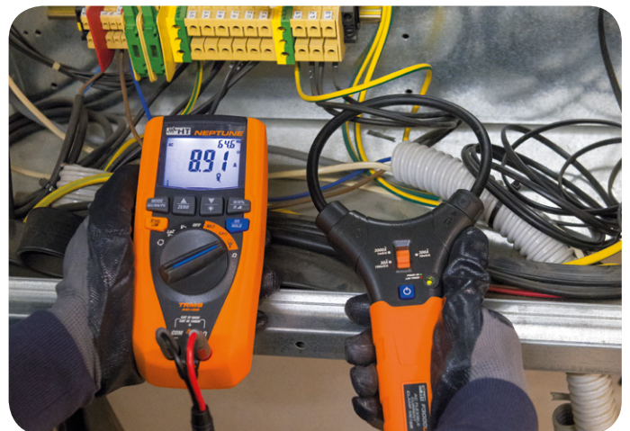
Mesure du courant à travers le transducteur flexible F3000U.
