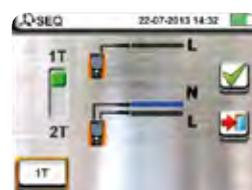
Sélection du type de mesure de la séquence des phases.
