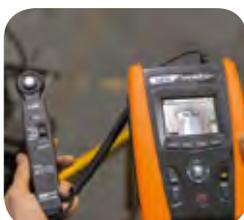
Mesure de Lux avec HT53/05.
