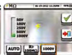
Sélection tension de test et valeur limite minimale sur mesure.
