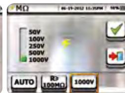
Sélection tension de test et valeur limite minimale sur mesure MQ.
