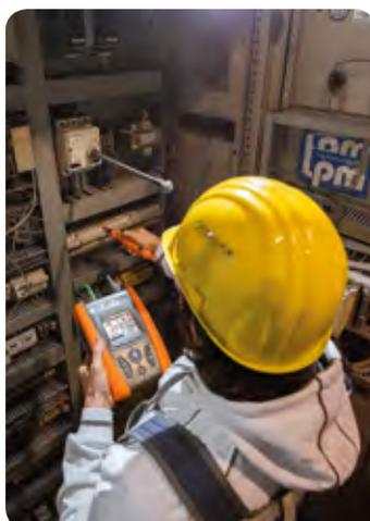
Marche/arrêt mesure avec embout à distance PR400.
