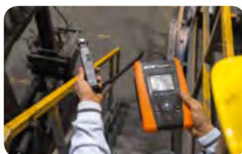
Mesure de Lux avec HT53/05.
