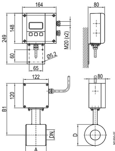
Grâce à sa faible longueur, le tube de mesure type III est souvent la bonne alternative pour un grand nombre d'applications. Equipé en standard d'un revêtement intérieur en PTFE, le type III peut supporter une pression nominale standard de PN 40.
