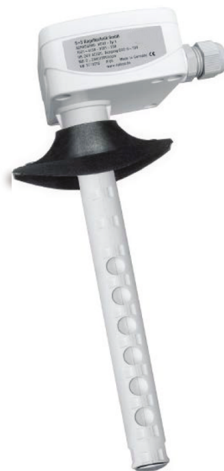
Sonde de qualité de l'air pour montage en gaine (COV) resp. convertisseur de mesure, y compris bride de montage, auto-calibrant, avec commutation multi-gamme et sortie active/tout ou rien
