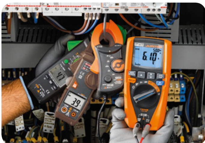
Comparaison des mesures: 3.9A: avec pince RMS - 4.7A: avec pince TRMS 6.1A: lecture correcte avec pince TRMS AC + DC.
