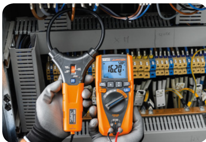
Mesure du courant alternatif avec capteur F3000U flexible.
