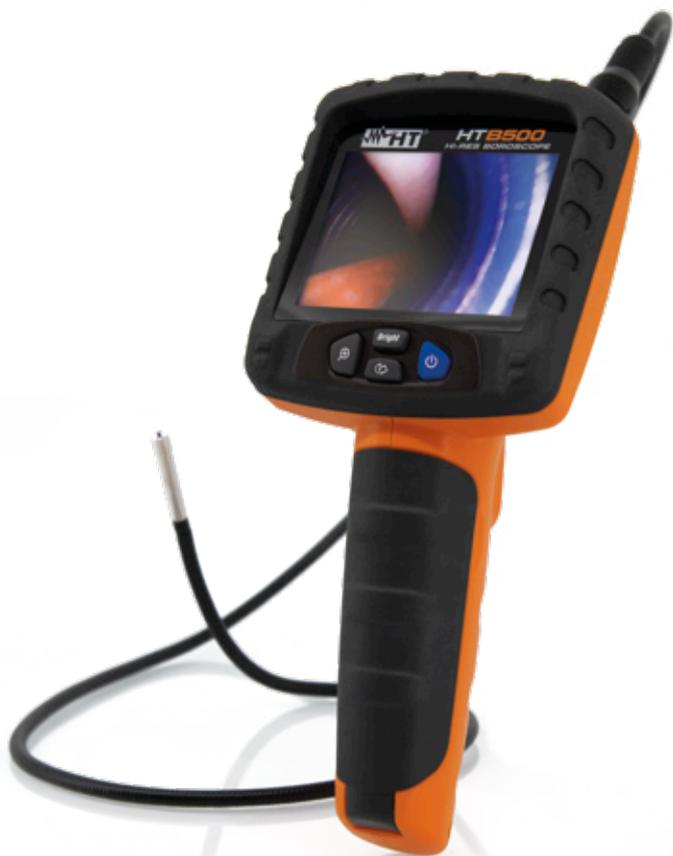
HTB500 est un boroscope numérique portable qui permet d'effectuer des inspections à l'intérieur de parties d'objets physiquement inaccessibles (typiquement des équipements rotatifs) et non visibles à l'œil nu. L'instrument utilise un palpeur externe étanche avec 4 LED à haute luminosité et un appareil photo, afin d'obtenir une image haute résolution sur l'écran.
