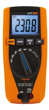
Multimètre professionnel pour mesure de l'isolement
