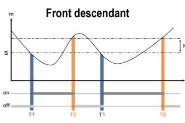
Mesure (m) < Seuil (S) pendant la temporisation T1 → Activation de l'alarme.
