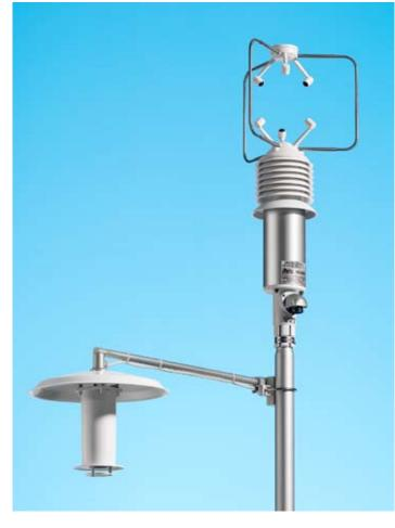
La mesure de la température de l'air est influencée par la temperature et par l'éclairement énérgetique lumineux et terrestre. Au moyen d'un écran approprie et de l'aspiration de l'air par un moteur electrique on peut mésurer la température de l'air en évitant que la mésure ne soit pas influencée par l'éclairement énérgetique solaire terrestre et par la convention thermique de l'écran.
