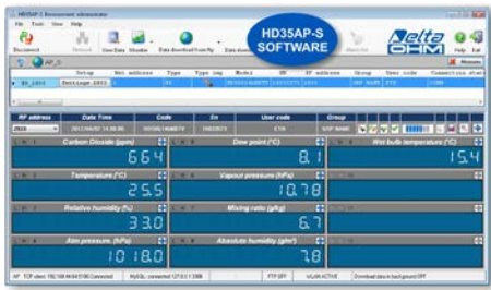
Logiciel HD35AP-S : visualisation des mesures temps réel
