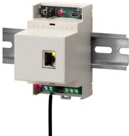
Enregistreur de données avec interface maître Modbus-RTU RS485 pour l'acquisition de capteurs avec sortie Modbus-RTU RS485 (par exemple un anémomètre de la série HD52.3D ...). Un protocole propriétaire est également disponible pour connecter les anémomètres de la série **HD2003**.
