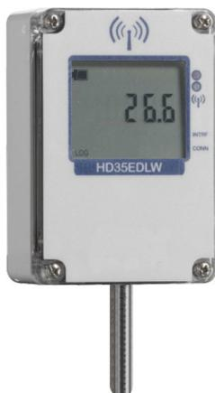
Enregistreur de données de température sans fil pour tunnels de congélation. Boîtier étanche **IP 67**. Affichage LCD personnalisé (uniquement avec l'**option L**). Il stocke les mesures dans sa mémoire interne (68 000 échantillons) et transmet automatiquement les données enregistrées à l'unité de base, à intervalles réguliers ou sur demande.
