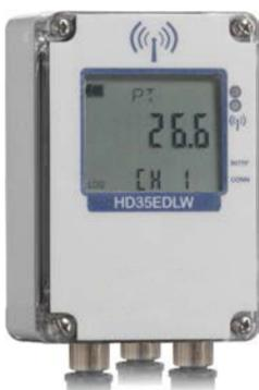
Enregistreur de température sans fil. Boîtier étanche **IP 67**. Afficheur LCD personnalisé (seulement avec l'**option L**). Il stocke les mesures dans sa mémoire interne (de 42.000 à 68.000 échantillons selon le nombre d'entrées) et transmet automatiquement les données enregistrées à l'unité de base à intervalles réguliers ou sur demande.
