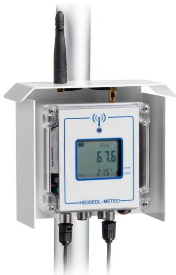
Enregistreur de données sans fil de température, humidité, pression atmosphérique (capteur interne), rayonnement solaire, quantité de pluie, vitesse et direction du vent. Boîtier étanche **IP 67**. Affichage LCD personnalisé (uniquement avec l'**option L**). Il enregistre les mesures dans sa mémoire interne (de 28 000 à 58 000 échantillons en fonction du nombre d'entrées utilisées) et transmet automatiquement les données enregistrées à l'unité de base, à intervalles réguliers ou sur demande.
