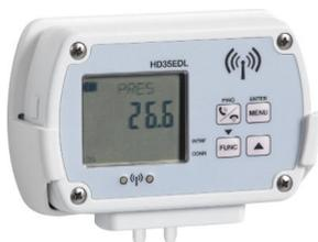
Enregistreur de données sans fil à pression différentielle. Convient aux salles blanches. Avec auto-étalonnage automatique de la pression différentielle à zéro. Affichage LCD personnalisé (uniquement avec l'option L). Il stocke les mesures dans sa mémoire interne (68 000 échantillons) et transmet automatiquement les données enregistrées à l'unité de base, à intervalles réguliers ou sur demande. Entrée de pression pour tubes Ø 5 mm.
