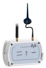
Appareil servant d'interface entre les enregistreurs de données réseau positionnés sur les sites de mesure et le PC. Il reçoit sans fil les données acquises par les enregistreurs de données distants et communique avec le PC via la sortie USB ou la connexion **3G / GSM / GPRS**. Ne nécessite pas l'installation de pilotes USB.
