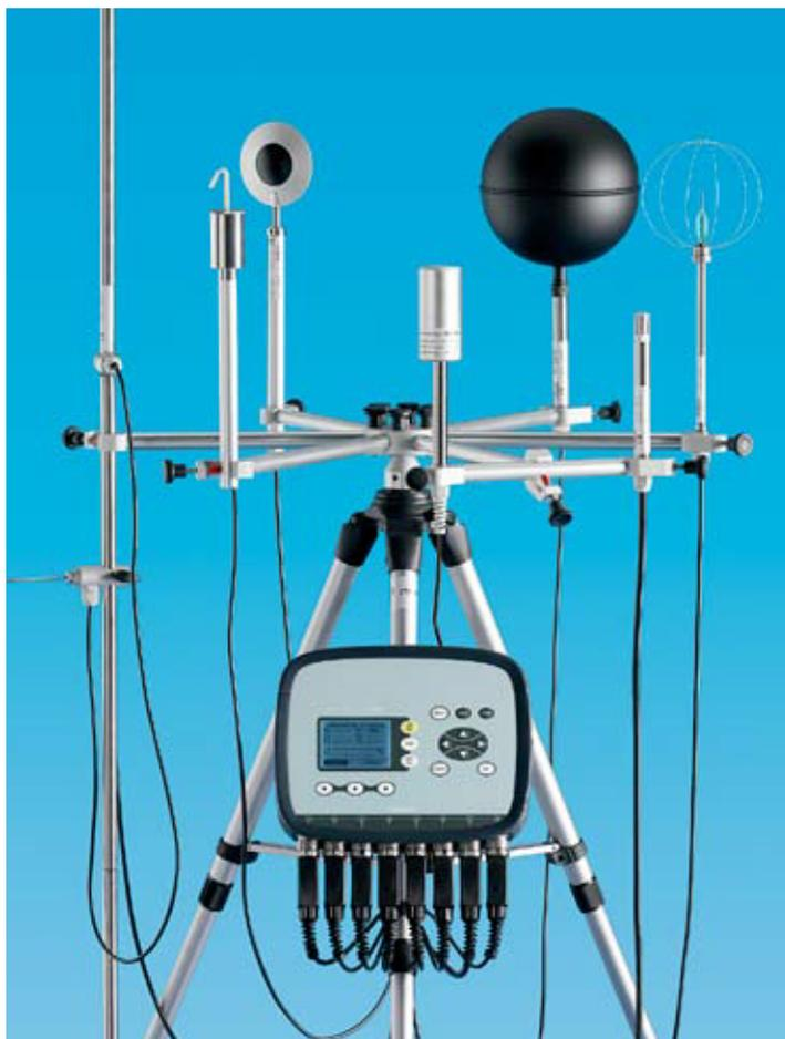
L' **HD32.1, Thermal Microclimate** est un instrument produit par C2Ai pour l'étude, la mesure et l'évaluation du Microclimat dans les milieux de travail, selon les normes:
