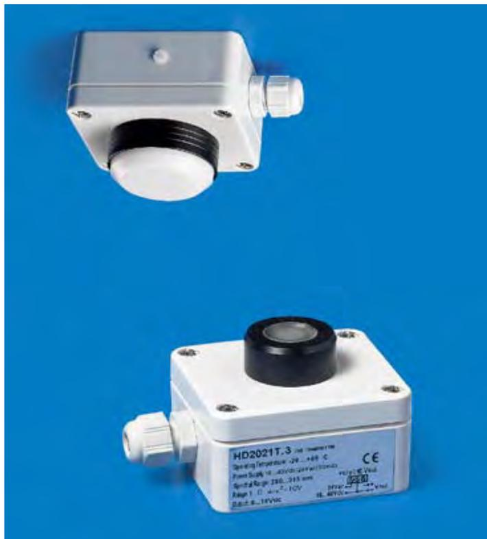
La série des transmetteurs HD 2021T ... , permet de convertir les grandeurs photométriques et radio métriques telles que; l'éclairage lumineux (Lux) et l'éclairage énergétique ( $W/m^2$ ) dans les gammes spectrales, UVA, UVB, UVC et dans la gamme 400 nm ÷ 1000 nm, en signal de tension 0 ÷ 10 V.
