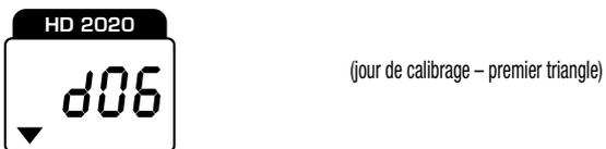
Au moyen de la touche SETUP on affiche le réglage de la date d'échéance du calibrage avec l'allumage du deuxième triangle à gauche et l'affichage du nombre d'années de validité du calibrage. On peut introduire le nombre des années et des mois entre la date de calibrage, insérée par le laboratoire qui fait la mise au point, et la date d'échéance. Lorsque l'intervalle réglé est terminé, le triangle clignote, ce qui indique qu'une nouvelle mise au point du calibre est nécessaire.
