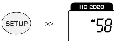
Chaque fois que les touches flèches sont appuyées, la valeur des secondes est mise à zéro. Au moyen de la touche SETUP on confirme et on va à la section relative au calibrage tandis que le petit triangle sur la gauche s'allume et l'année de calibrage est affichée (le paramètre ne peut pas être modifié par l'utilisateur).
