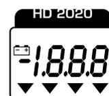
**Note: entre la pression de la touche ON/OFF et l'allumage de l'écran trois secondes s'écoulent: c'est le temps nécessaire pour effectuer l'auto test initial.**
