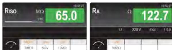
Mesure de résistance d'isolement
