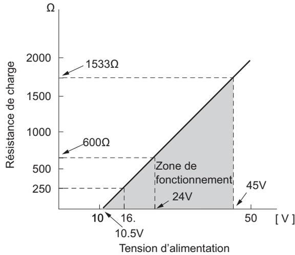
Note: la communication avec le communicateur FXW nécessite une charge mini de 250Ω
