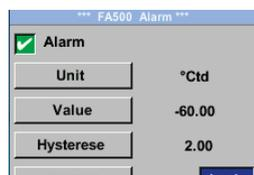
La valeur du seuil d'alarme peut être paramétrée grâce au clavier. Vous pouvez également sélectionner librement l'hystérésis.
