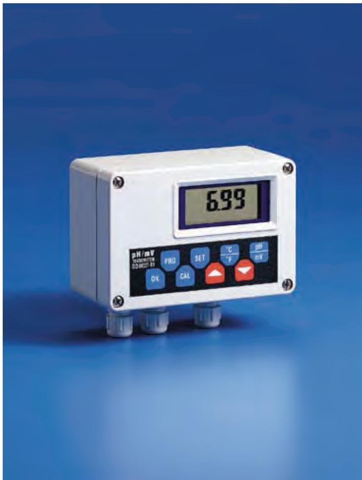
Le transmetteur de pH **DO 9403T-R1** transforme la sortie d'une électrode de pH, compensée en température, en un signal 4÷20 mA. Le circuit d'entrée de l'électrode de pH ou Redox est isolé galvaniquement par le signal de sortie 4÷20 mA. Un indicateur à LCD permet de visualiser la valeur du signal de processus et les différents paramètres.
