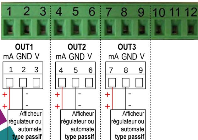
> Raccordement de la sortie tension 0-5/10 V :
