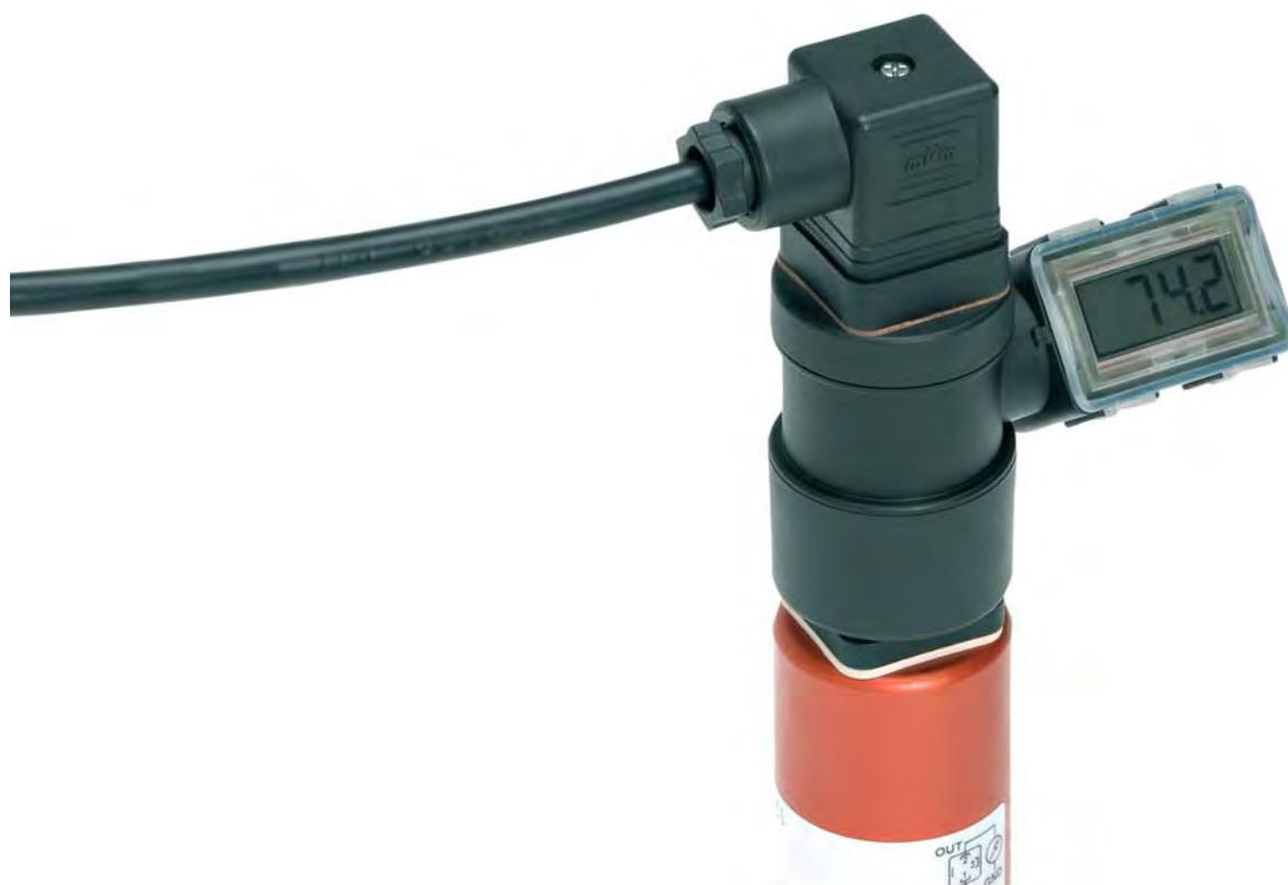
Les modules d'affichage de la série 801 peuvent être montés sur tous les capteurs à connectique DIN EN 175301- 803-A. Peu importe la position de montage du capteur, le module peut être tourné et orienté pour obtenir une position de lecture idéale. Le module d'affichage est équipé d'un afficheur à 3 digits à cristaux liquides et peut être réglé en usine et par le client.
