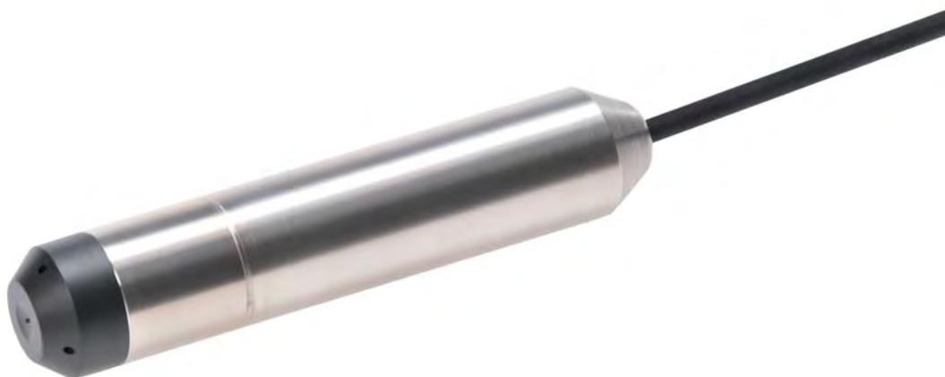
Les sondes de niveau type 712 possèdent une cellule de mesure de pression relative ou absolue. Les sondes de la série 712 délivrent un signal de mesure étalonné et amplifié. Des longueurs de câble de 2 à 30 mètres sont disponibles. Une version avec protection contre l'explosion, ainsi qu'une version avec mesure de température intégrée sont également proposées.
