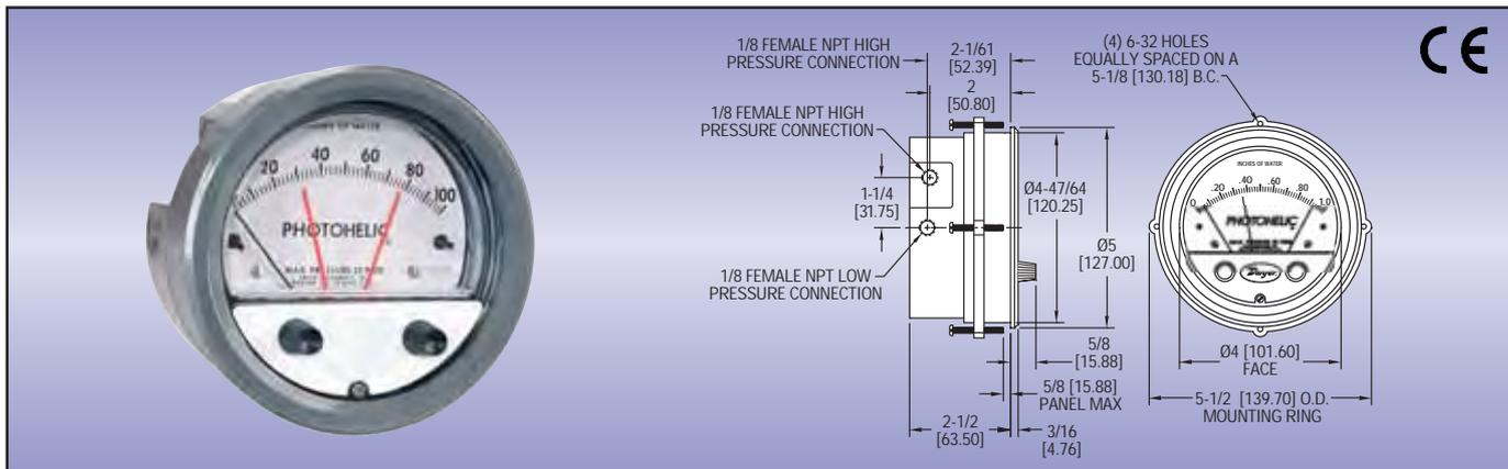
Les indicateurs / contrôleurs de pression Photohelic des séries 3000Mr et 3000MRS combinent les fonctions de pressostats de pression différentielle précis et hautement reproductibles avec celles d'un indicateur de pression analogique éprouvé et à longue durée de vie Magnehelic. Des boutons moletés externes sur la face avant de l'indicateur permettent un réglage aisé des points de consigne.
