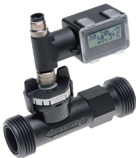
Les débitmètres de la série 212 reposent sur le principe des chemins de Vortex de Karman. Au choix, des versions avec mesure de température intégrée sont disponibles. Ce débitmètre se distingue par un afficheur digital intégré qui indique le débit et la température du fluide.
