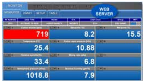
Web serveur : Contrôle des mesures avec une alarme sur le taux de CO2
