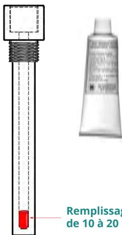
Remplissage de la graisse silicone de 10 à 20 mm max dans le DDG
