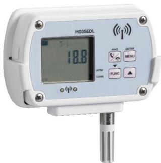
Enregistreur de données de température sans fil. Affichage LCD personnalisé (uniquement avec l'option L). Il stocke les mesures dans sa mémoire interne (68 000 échantillons) et transmet automatiquement les données enregistrées à l'unité de base, à intervalles réguliers ou sur demande. Sonde verticale à température fixe avec capteur de température NTC10K $\Omega$ . (métrologiquement suivie)
