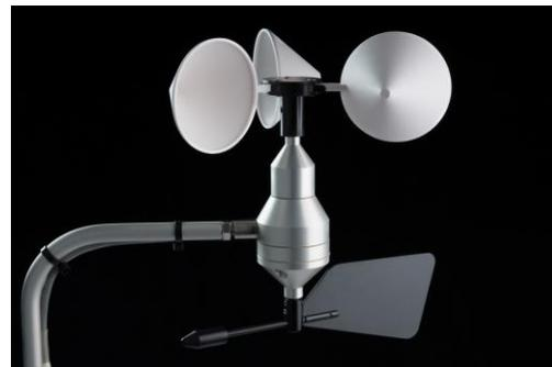
(1) La mise en route est définie comme la vitesse nécessaire pour que les gobelets bougent à partir d'un arrêt par vent nul. Cependant, dans la pratique, un anémomètre s'arrête rarement et des vitesses de vent très faibles peuvent être détectées grâce à l'assemblage de la coupelle à faible inertie.
