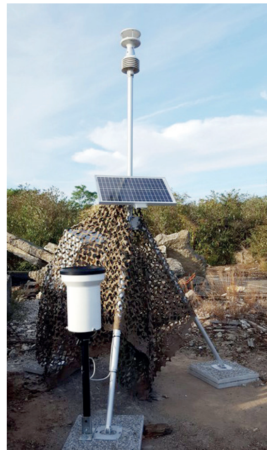
Station météo autonome sur panneau solaire et transmission GSM
