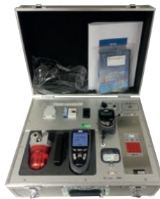
Malettes de surveillance de pression différentielle pour le désamiantage
