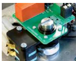
Limiteur de couple et report défaut Si l'actionneur est soumis à un couple trop élevé, il se met immédiatement en sécurité grâce à un limiteur de couple mécanique. Le câblage d'un contact sec lors de l'installation de l'actionneur permet d'être immédiatement informé de cet état. Sécurité, simplicité et tranquillité d'utilisation.
